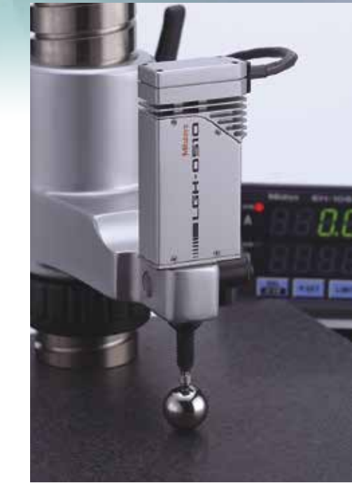
※针型测头安装示例
