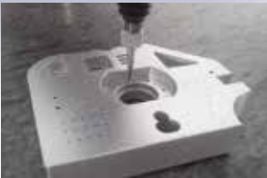
※针型测头安装示例
