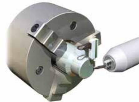
③ 加工机刀具长度测量
