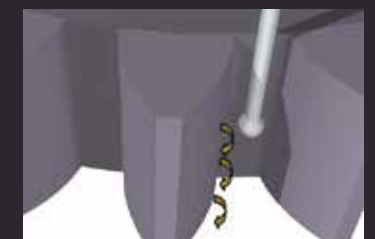
细微齿轮 齿形 / 齿线测量
