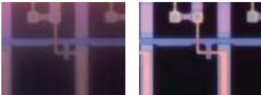
不使用校正（50 倍） 使用 0.7 mm（50 倍）校正
